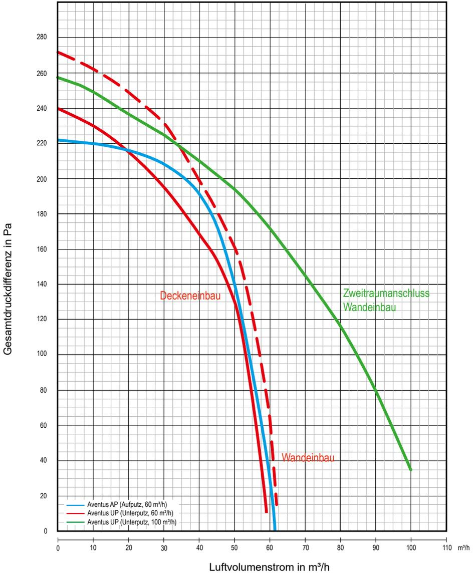
Abbildung 12: Luftvolumenstromentwicklung Abluftventilator Aventus
