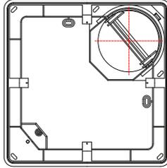
Feder der Rückschlagklappe entfernen!
