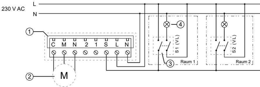
Abbildung 8: Anschlussplan Steuerungselektroniken Typen 60 N / 60 NF / 100 N / 100 NF
