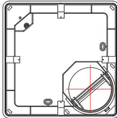
Feder der Rückschlagklappe in drittes (äußerstes) Einhängeloch umsetzen!
