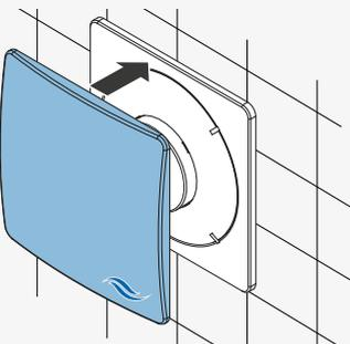
**TIPP:** Es besteht keine Verbindung zwischen der Grundplatte der Innenblende und dem Gehäuse mit dem Ventilatoreinsatz. Durch die Krallen wird der Halt sowohl im Gehäuse als auch im Mauerwerk oder Innenputz/-aufbau gewährleistet. Das nachträgliche Erhöhen des Innenaufbaus ist jederzeit möglich.
