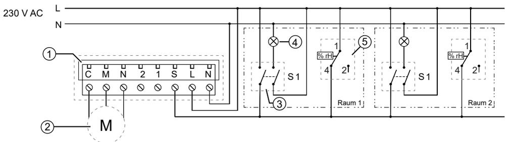
Abbildung 9: Anschlussplan Steuerungselektroniken Typen 60 N / 100 N mit Hygrostat (extern)
